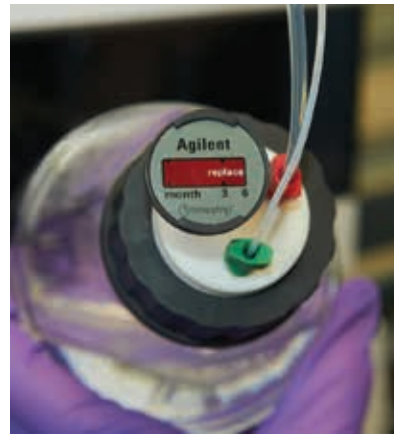
Monitor prático de filtro: a faixa sinalizadora de tempo de uso monitora a necessidade de substituição do filtro.
